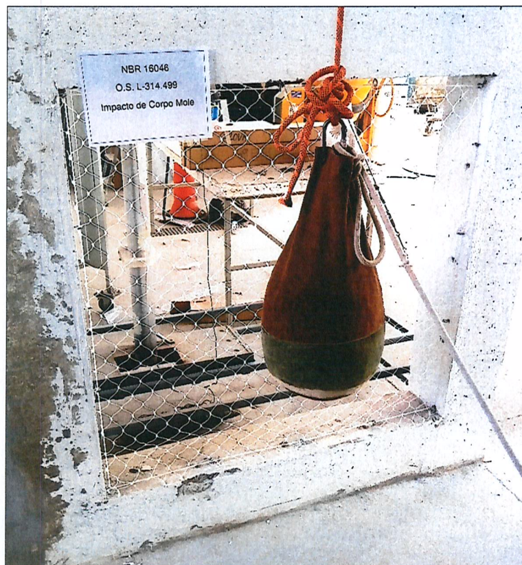
Foto n.º 01 – Visualização do ensaio de resistência ao impacto
