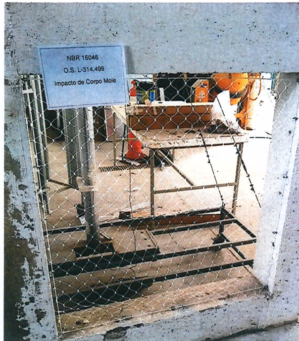
Foto n.º 02 – Visualização do ensaio após o impacto de corpo mole
